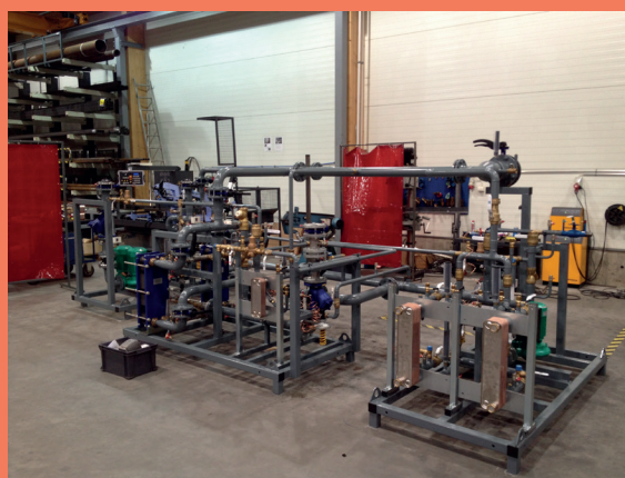
2 из 9 тепловых пунктов перед отгрузкой на площадку
