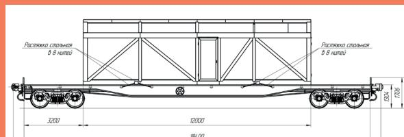
Корпус контейнера выполнен со сварной пространственной рамой из стальных гнутых профилей с ребрами жесткости, изнутри блок-контейнер обшит трехслойными оцинкованными сэндвич-панелями с утеплителем из минваты нужной толщины группы горючести Г. Рабочие условия эксплуатации – от -40 до +40°C, предельные условия – от -50 до +50°C.
