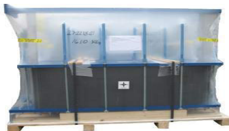
Рис.4 Пример упаковки разборного пластинчатого теплообменника
