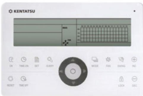
Центральные пульта KCC-41 и KCC-42 предназначены для управления группой внутренних блоков (не более 64) системы DX PRO. Пульта позволяют устанавливать все рабочие параметры внутренних блоков и имеют функцию блокировки работы блоков, функцию напоминания о наступлении срока обслуживания фильтра. Модели имеют одинаковый внешний вид, но предназначены для работы с разными системами DX PRO.
