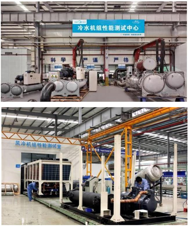
Лаборатория агрегатов с воздушным и водяным охлаждением для AHRI certified
