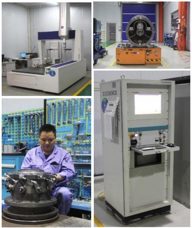
Трёхкоординатный измерительный стенд 0.001 mm
