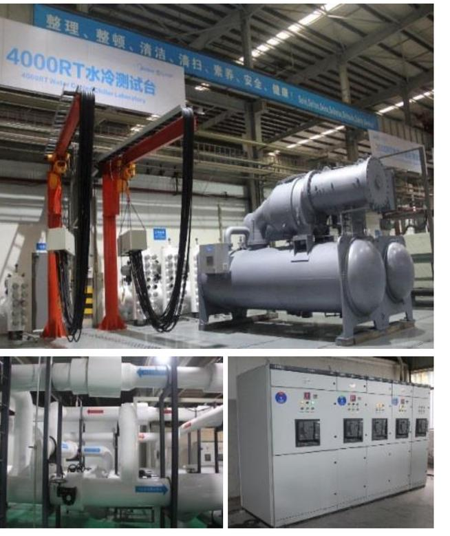
Испытательный центр чиллеров с водяным охлаждением мощностью до 14 МВт
